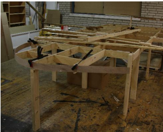
Her ses, at rammekanten ny er ret på bagsiden ud mod gangen op mod midtervæggen. Der arbejdes med at bygge rammen midt for vinduerne i gavlen.
