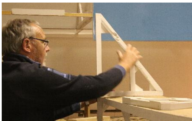
Niels i gang med at montere et knæ bag på en lyskasse.
