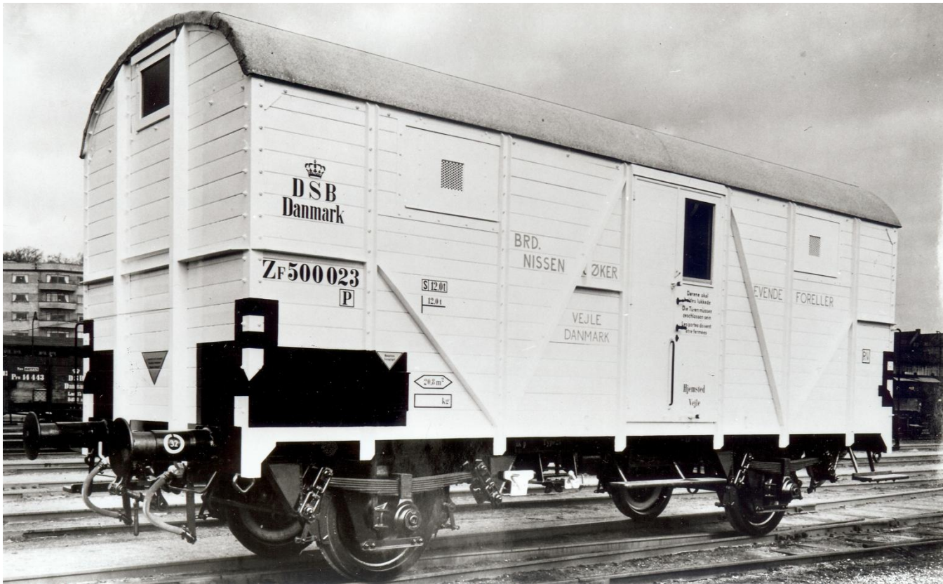
ZF 500 023. 1953. I årene efter krigen skete der en voldsom udvikling af vognene. Denne vogn er et godt eksempel. Man har umiskendeligt en vognkasse fra IA / HD serierne, men undervognen er helt moderne og vel en slags forløber for G vognene, der kom året efter. Foto.: Scandia. Arkiv.: JMJK.
