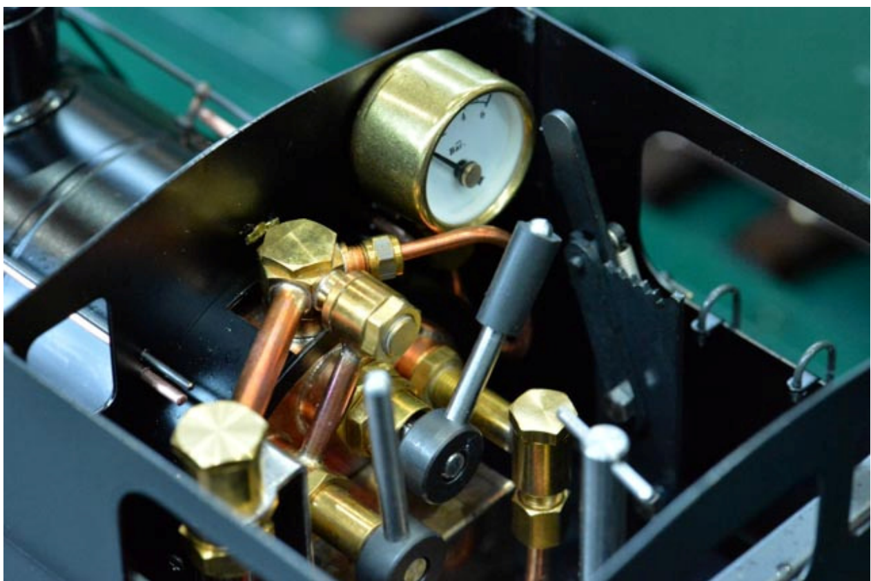
Armaturerne i en Alster TIGERLI spor 1 Live Steam. Vandstandsglasset kan ikke ses på billedet.
