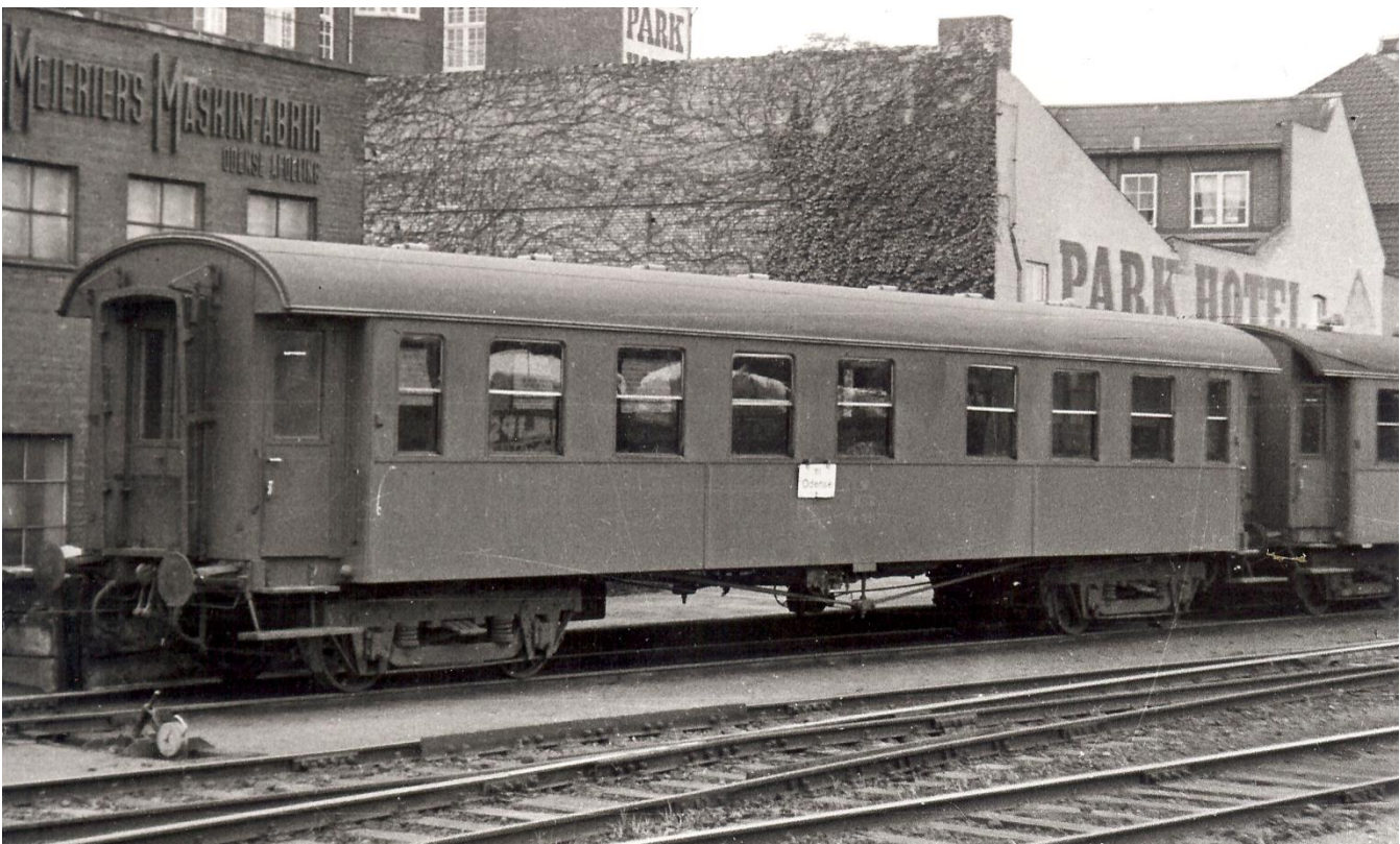
CP 3211. Vognen er ombygget i januar 1948, det passer fint med "kuck - kuck" ventilerne og batteri placering. Odense 1963.
