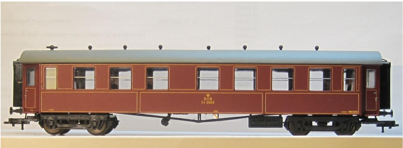
Heljans model af CP 2883 fra 2008. Taget gaber lidt, en skavank mange CP vogne lider af. Problemet lader sig rimeligt let afhjælpe ved at fjerne støbegrater og afpudsning af interiør og vinduer.
