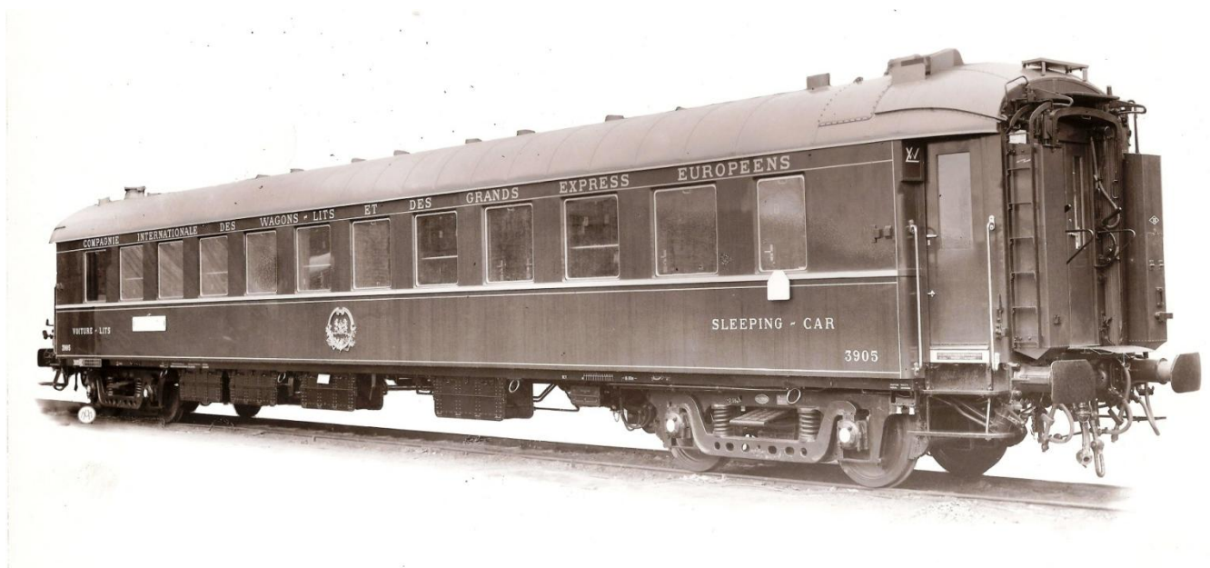
WL type Y 3905. Fabriksfoto fra Nivelles 1949, vognen kom til at køre en hel del med Danmark som stationeringssted. Det var den sidste type sovevogne bygget efter det grunddesign, CIWL indførte i 1922 med type S. Arkiv.: Steffen Dresler.
