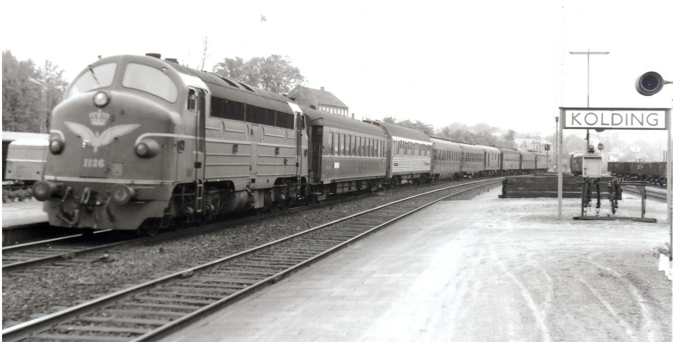
MY 1136 med Nord Ekspres i Kolding 1960. Bag maskinen følger en WL YT, en WL P, denne vogntype har aldrig været stationeret i Danmark, men sås lejlighedsvis i eksprestogene. Bag P vognen er det to hollandske vogne, en fransk "Rapide Nord" bagagevogn, endnu en Y vogn, en ukendt vogn og bagerst spisevognen (Nyborg - Osnabrück). Foto.: Ove Winther Lauersen. Arkiv.: Hans Gerner Christiansen.
