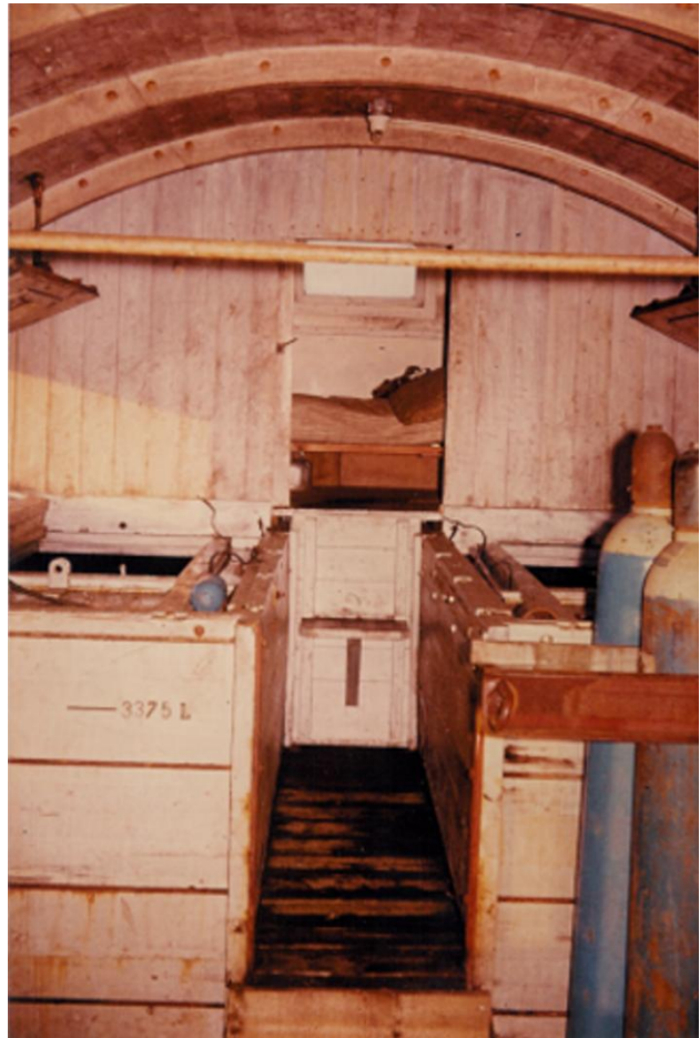
Den ene og den anden ende af ZF 500 121. De fire bassiner på i alt 13.600 liter fylder sammen med de mange iltflasker ganske godt i den ellers store vogn. På billedet til højre ses lidt af ledsagerens "suite". Her kunne han opholde sig, få lidt varme, sove, spise, når fiskene ikke krævede hans opmærksomhed.
