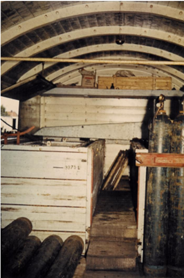
Den ene og den anden ende af ZF 500 121. De fire bassiner på i alt 13.600 liter fylder sammen med de mange iltflasker ganske godt i den ellers store vogn. På billedet til højre ses lidt af ledsagerens "suite". Her kunne han opholde sig, få lidt varme, sove, spise, når fiskene ikke krævede hans opmærksomhed.
