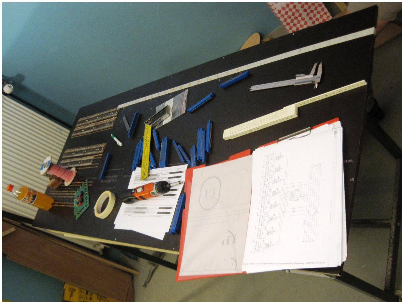
Et billede fra sidst onsdag (02.07.). De blå "dimser" er sokler til printpladerne med styringerne til skifter / tilbagemeldinger.
