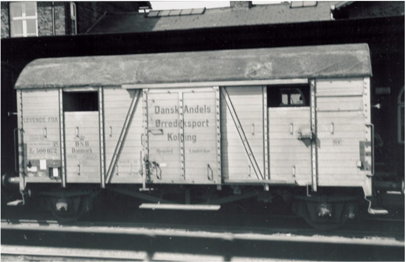
ZF 500 072 i Bramminge 1951. Det er, trods forvandling til dansk ZF vogn, umiskendeligt en Gms 30 "Opplen". Vognen blev senere ombygget væsentligt, herved mistede den en stor del af det tyske præg.
