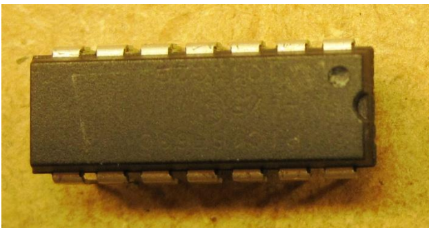
Dette er en PIC (Programmerbar Integreret (C) Kreds), sådan en dims kan styre 4 skifter / magnet artikler/ motorer.
