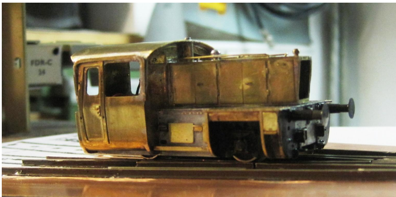
En Köf er en (dejlig) lille sag, i skala Ho, men det udelukker ikke de mange små og fine detaljer! Modellen har en fin vægt, takket være overdelen fremstillet af messingplade.
