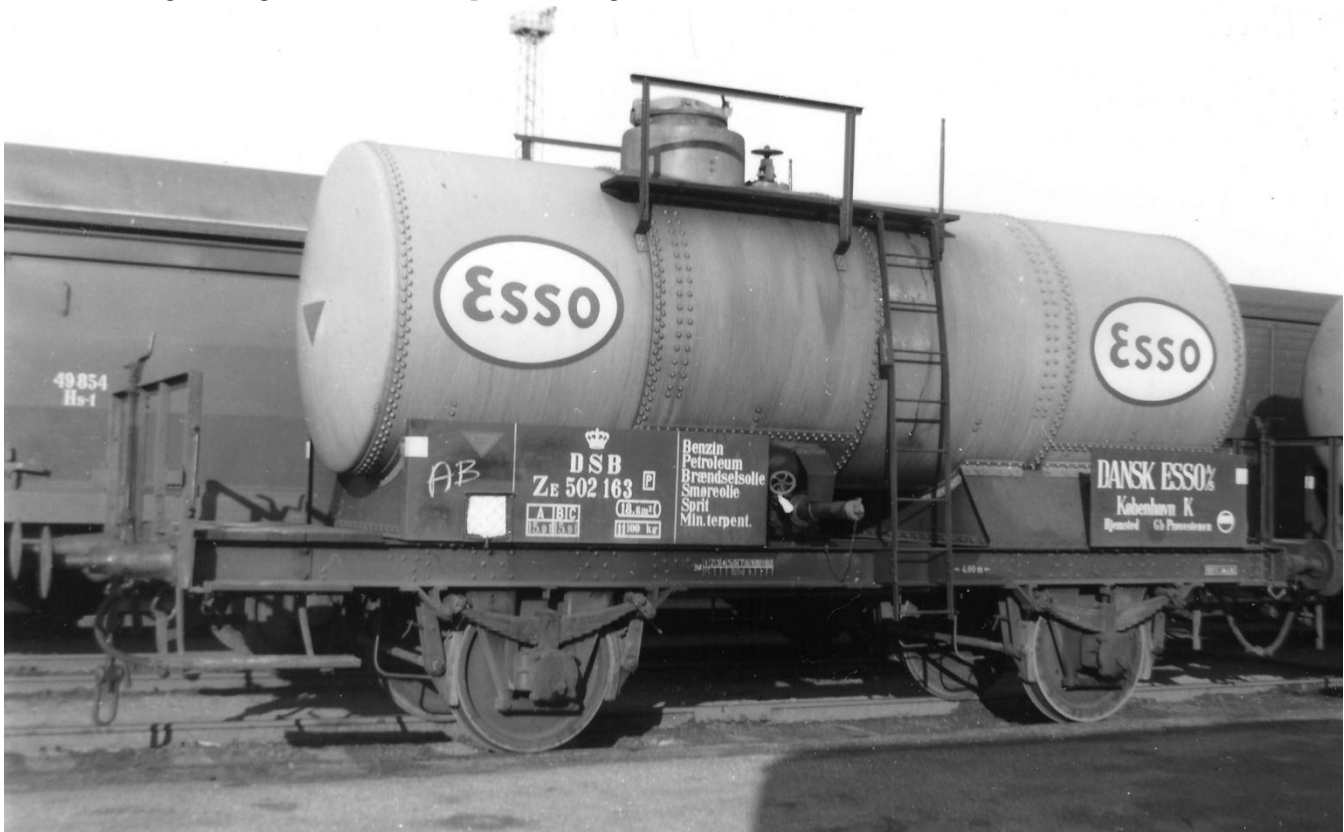
ZE 502 163. i 1964. vognene har nu fået flyttet alle (undtagen logo) ned på 2 påskriftplader, bærekonsoller til tanken er nu sort som undervognen og bremsehus er fjernet. Foto.: C. Oddershede.
