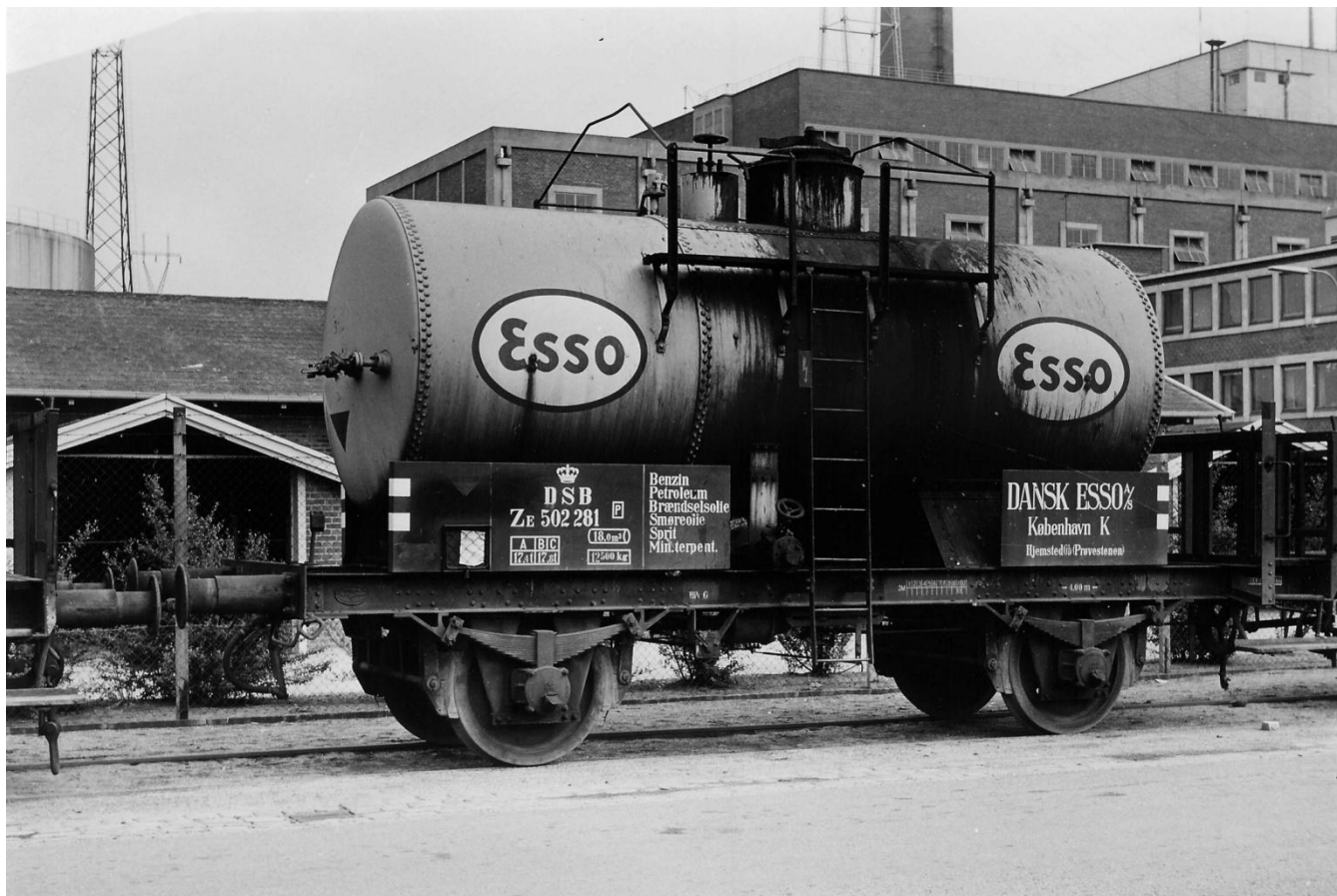
ZE 502 281 i to udgaver, øverst er den fanget i Snekkersten i 1955. Her ses at tanken er isoleret og sortmalet, 14 år senere er vognen fotograferet i Odense, nu er isoleringen og svøb fjernet. Efter tankens udseende at dømme har denne været fjernet et stykke tid.
