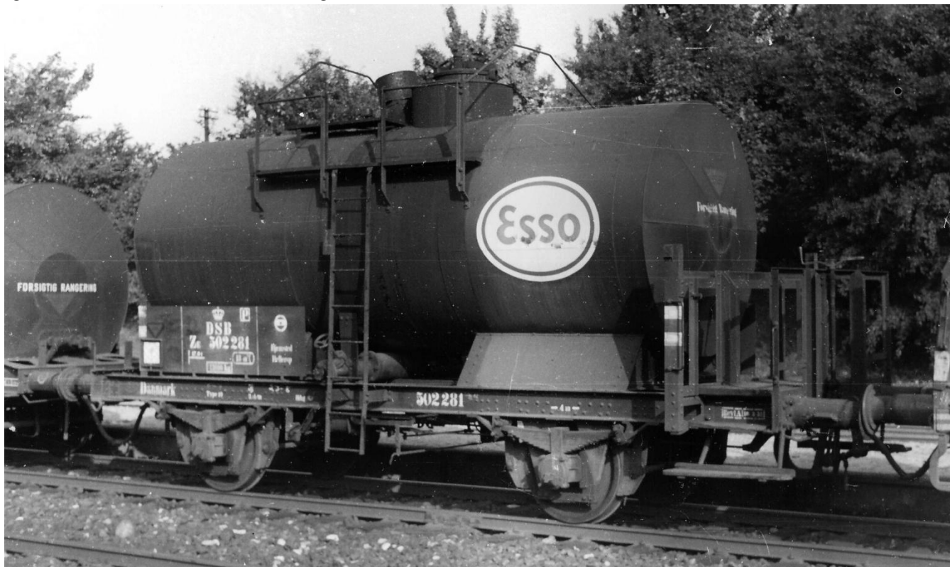
ZE 502 281 i to udgaver, øverst er den fanget i Snekkersten i 1955. Her ses at tanken er isoleret og sortmalet, 14 år senere er vognen fotograferet i Odense, nu er isoleringen og svøb fjernet. Efter tankens udseende at dømme har denne været fjernet et stykke tid.
