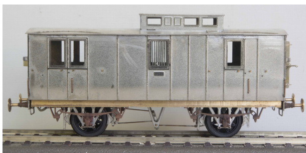
Modellen er ikke færdigbygget. Der mangler overgangsbros, skorsten fra koksovn og noget af bremsetræktøjet
